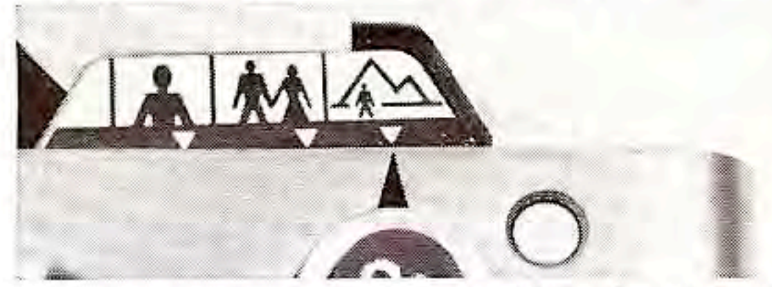
Landschaftsaufnahmen, alles über 3 m ... Entfernungsskala so einstellen. ▼
